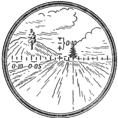
Рис. Измерение углов биноклем
